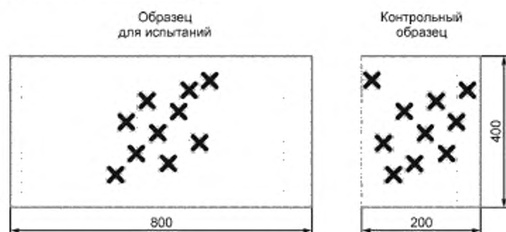
Рисунок 2 — Схема отбора образцов пучков ворса из контрольного образца и образца после проведения испытания
