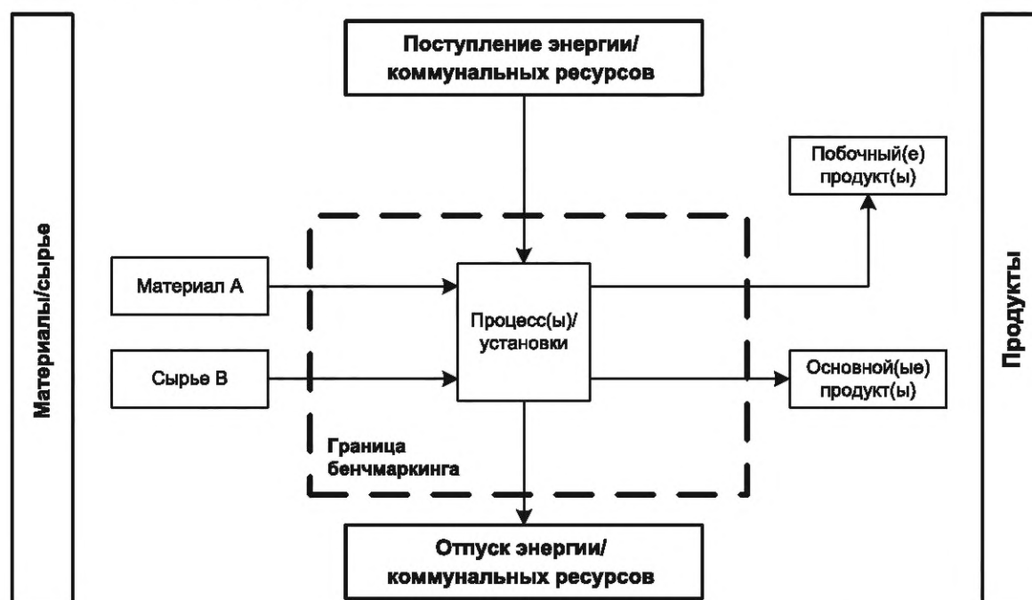
Рисунок В.1 — Пример потоковой диаграммы с границей бенчмаркинга для бенчмаркинга в обрабатывающей промышленности
