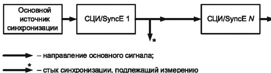
Рисунок 1 — Схема измерений параметров синхронизации по пункту 1 таблицы 1
