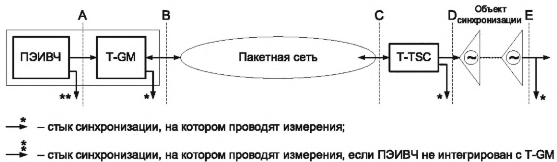
Рисунок 13 — Стыки синхронизации сети СШВ, подлежащие измерению, для случая, когда T-TSC является внешним для объекта синхронизации
