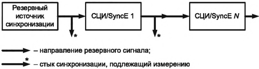
Рисунок 4 — Схема измерений параметров синхронизации по пункту 4 таблицы 1
