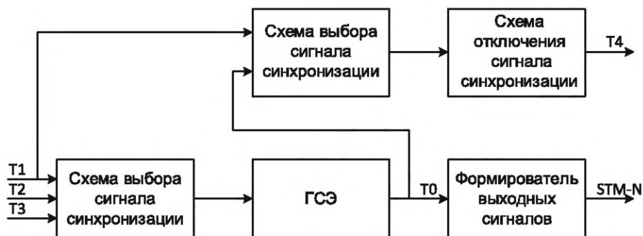
Рисунок 1 — Схема распределения сигнала синхронизации в мультиплексоре СЦИ
