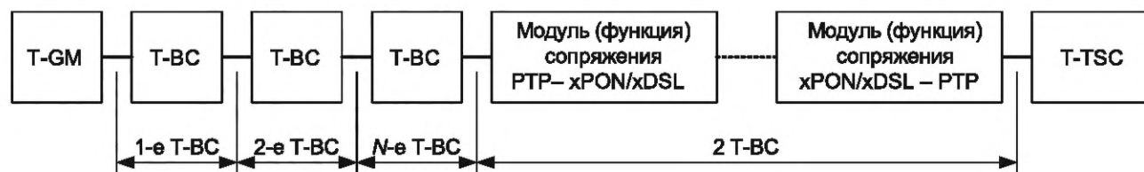
Рисунок Г.6 — Модель цепи синхронизации, включающей участок с оборудованием xPON или xDSL
