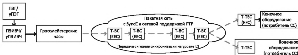
Рисунок 16 — Обобщенная архитектура фазовой/временной синхронизации в сетях связи с полной сетевой поддержкой PTP для телекоммуникационного профиля PTP (см. [16])
