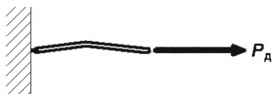
в) схема приложения нагрузки к дополнительному стержню
