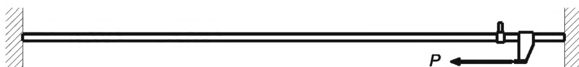
б) схема приложения нагрузки к основному стержню
