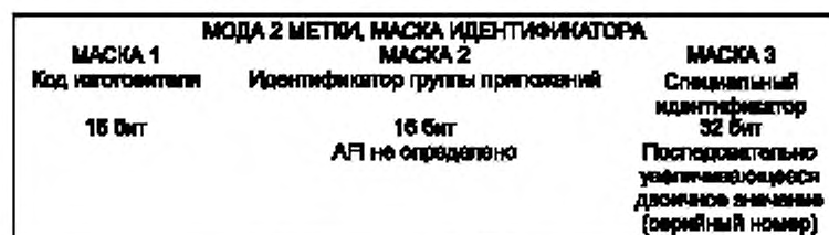
Рисунок 9 — Логическая организация идентификатора радиочастотной метки
