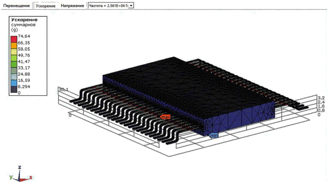
Рисунок А.7 — Суммарные ускорения во всех точках конструкции ЭКБ на резонансной частоте
