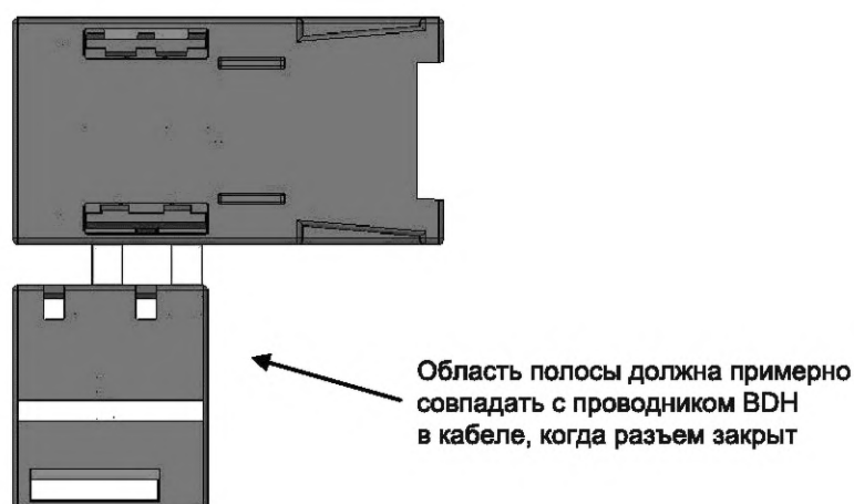
Рисунок 114 — Маркировка разъема для магистральных линий
