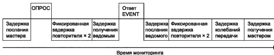
Рисунок 61 — Модель передачи событий ведомому устройству
