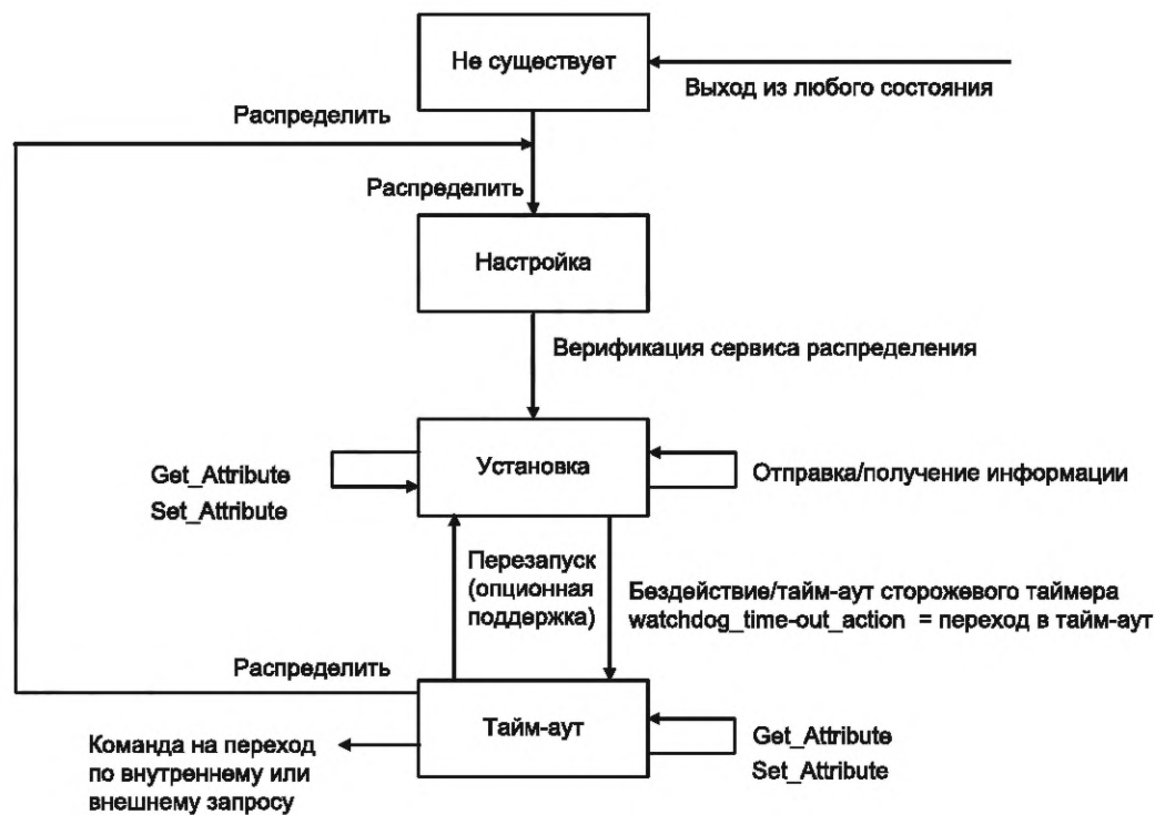
Рисунок 41 — Предопределенная диаграмма перехода состояния ввода-вывода «ведущий/ведомый»
