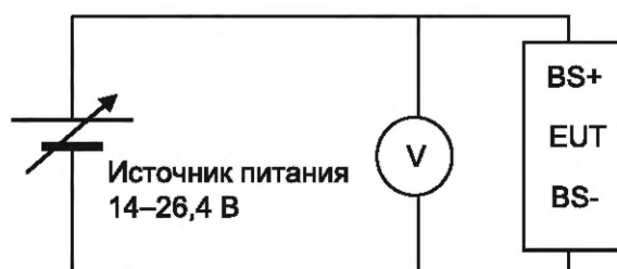
Рисунок 119 — Схема проверки рабочего напряжения
