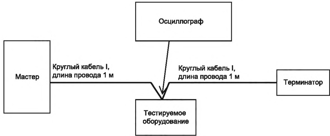
Рисунок 123 — Схема испытаний выхода порта ведомого устройства
