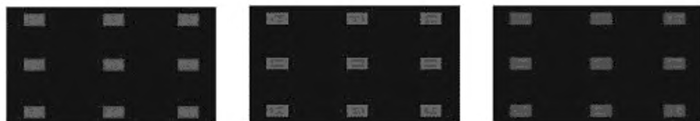
Рисунок 11 — Девять цветных окон для измерения из точки наиболее благоприятного просмотра
