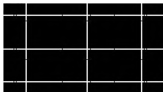
Рисунок 10 — Девять измерительных точек для измерения черного из точки наиболее благоприятного просмотра
