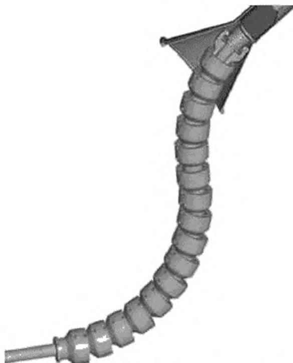
Рисунок 5.4 — Ограничитель изгиба J-образного трубопровода
