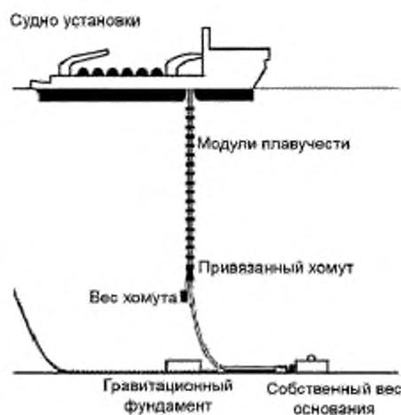
Рисунок 15.4 — Установка хомута каната
