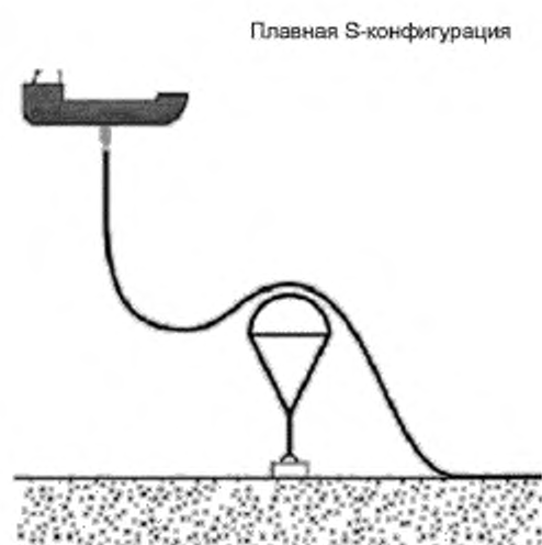
Рисунок 5.15 — Плавная S-конфигурация гибкого трубопровода
