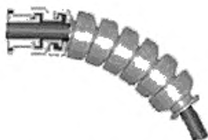
Рисунок 7.15 — Обхватываемая конструкция соединения ограничителя изгиба
