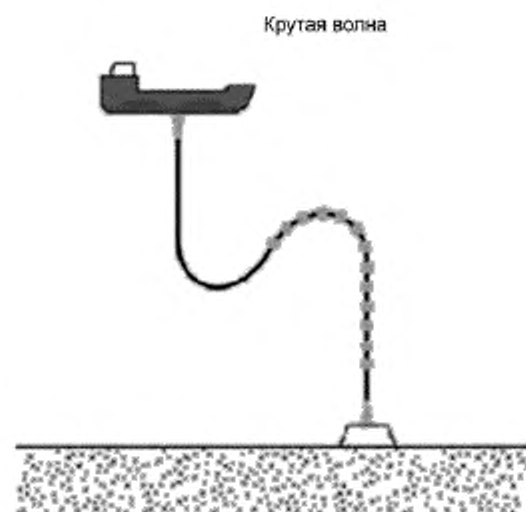
Рисунок 5.11 — Конфигурация гибкого трубопровода в виде крутой волны
