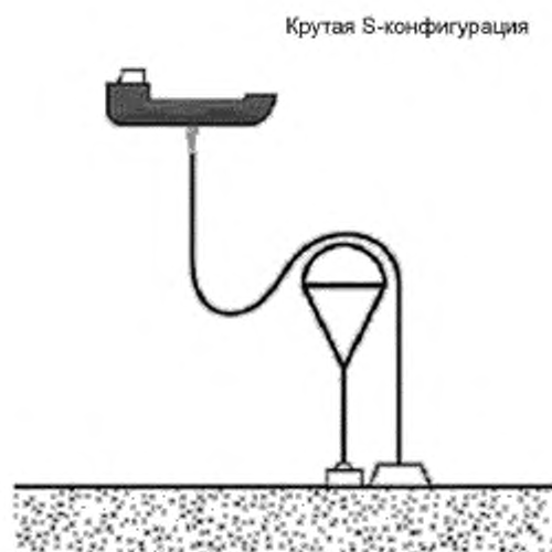
Рисунок 5.16 — Крутая S-конфигурация гибкого трубопровода
