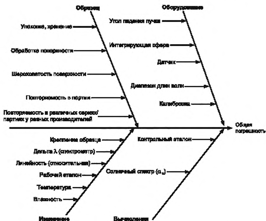
Рисунок F.1 — Основные параметры при выполнении измерений
