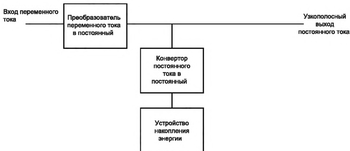
Рисунок В.3 — Линейно-интерактивная топология преобразования
