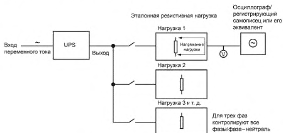
Рисунок 5 — Метод испытаний линейной нагрузки
