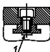
1 — концы болта не должны достигать нижней части гайки
