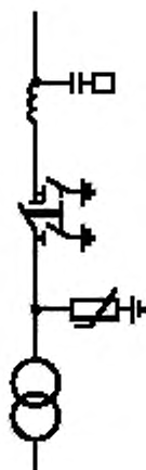
Рисунок 1 — Схема 35-1. Блок (линия—трансформатор) с разъединителем
