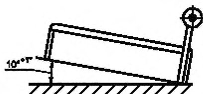
Рисунок 3 — Испытание скамьи на устойчивость в продольном направлении
