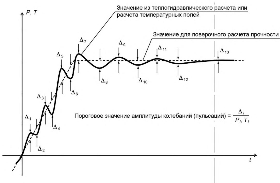
Рисунок 5.2 — График изменения давления и температуры для одного режима
