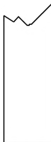
Рисунок В.10 — Разрушение при сжатии типа AGM: разрушение через центр отверстия вдоль осей армирования слоев ламината, в основном расположенных под углом \pm 45^\circ
