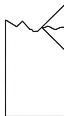
Рисунок В.8 — Разрушение при растяжении типа MGM: многотиповое разрушение через центр отверстия (сопровождается деламинацией и разделением на части)
