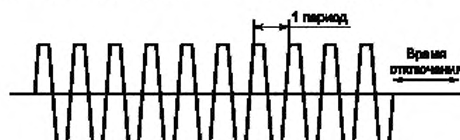
Рисунок 8 — Пример трапецевидной формы градиентного сигнала
