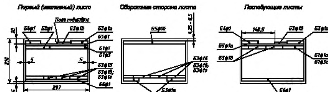
Рисунок А.1 — Пример расположения графических изображений блоков основной надписи для форм документов формата А4 с горизонтальным расположением поля подшивки
