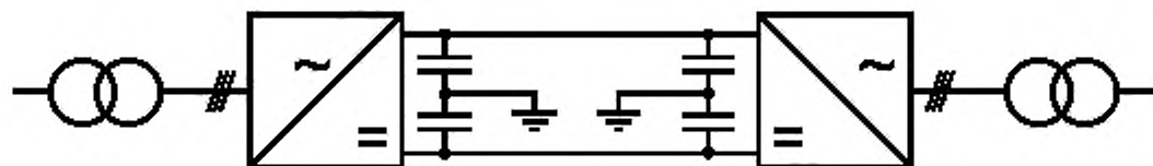
Рисунок 8 — Симметричная монополярная система ПТВН на основе преобразователей напряжения с заземлением средней точки конденсаторов на стороне постоянного тока
