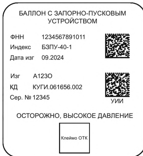
Рисунок 6 — Представление таблички с данными уникальной идентификации и дополнительными данными (ФНН, индекс и дата изготовления изделия)
