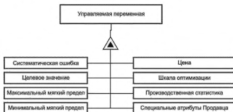
Рисунок 13 — Информационная модель управляемой переменной CV
