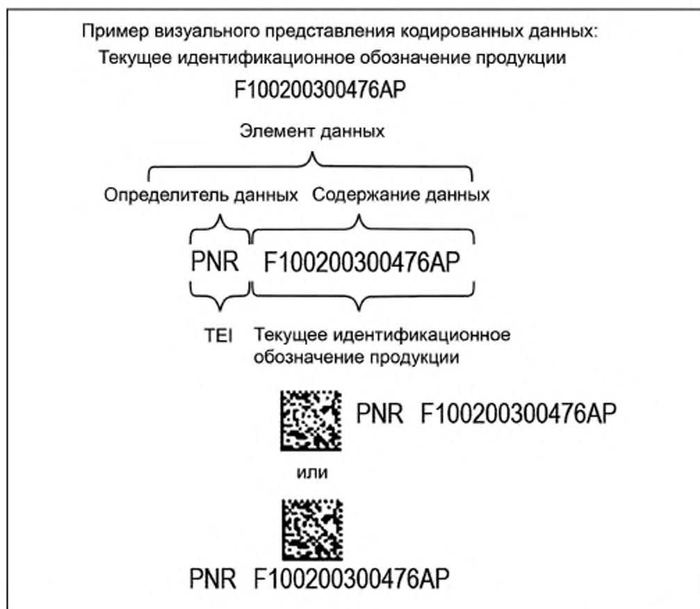
Рисунок 9 — Пример представления данных для визуального чтения, данные кодированы с применением идентификаторов TEI
