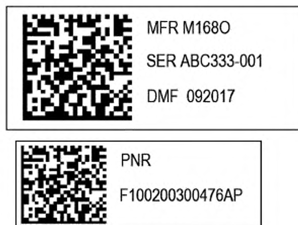
Рисунок 6 — Сокращенный состав данных, матричные символы штрихового кода, поле «PNR» на отдельной табличке
