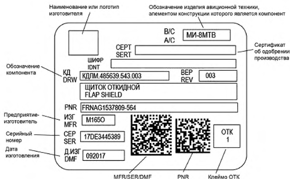
Рисунок 3 — Опознавательная табличка с полным составом данных по [1] для компонента АТ II класса с полем «ШИФР», поле «PNR» на основной табличке в отдельном символе штрихового кода
