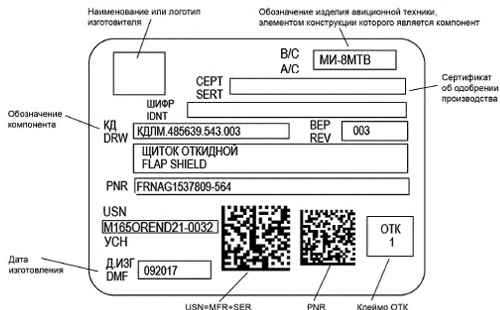
Рисунок 8 — Маркировка на опознавательной табличке с полным составом данных компонента АТ II класса по [1] и полем «USN»
