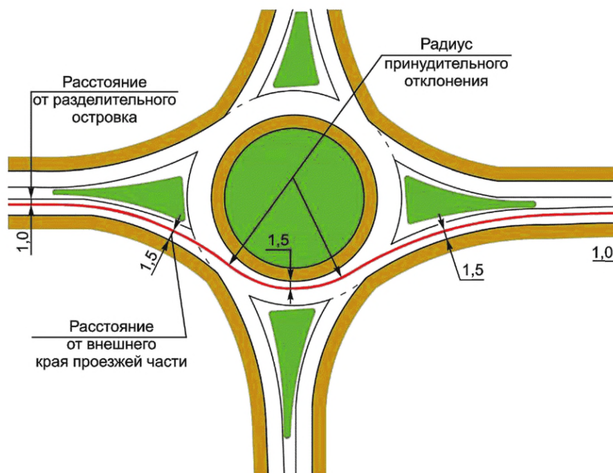
а) Проезд однополосного кольцевого пересечения в прямом направлении
