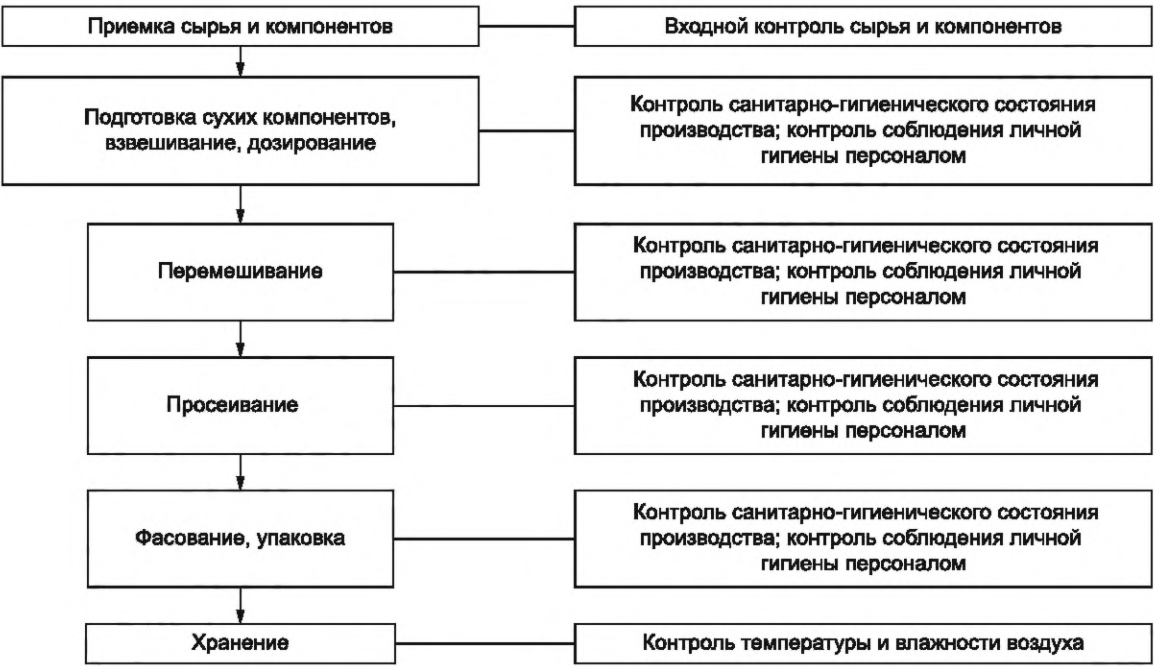
Рисунок Б.2 Блок-схема производства сухой адаптированной молочной смеси (сухое смешивание)
