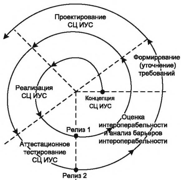
Рисунок 5 — Спиральный (эволюционный) жизненный цикл разработки СЦ ИУС
