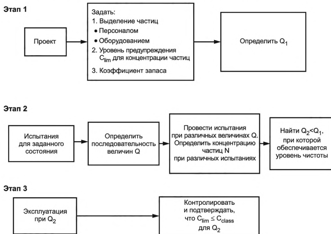
Рисунок 3 — Последовательность действий при определении расхода воздуха для обеспечения чистоты по концентрации частиц на этапах: проект — испытания — эксплуатация
