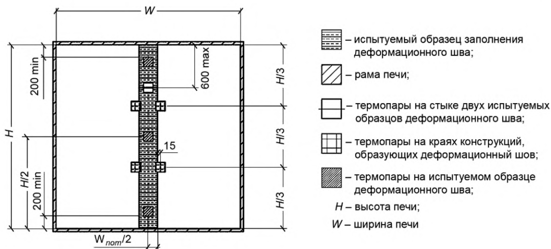
Рисунок 13 — Типовая схема расстановки термодатчиков (вертикальная печь)
