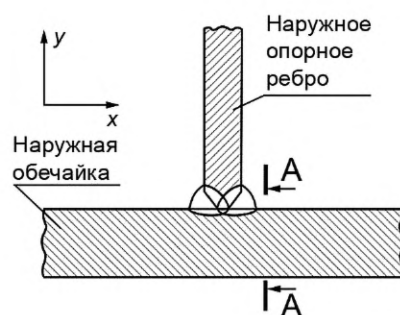
Рисунок Н.3 — Узел, образованный продольным стыковым сварным швом сварки секций бака (узел VI)
