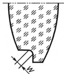
Рисунок 28 — Обозначения ширины скругления внутренней кромки
