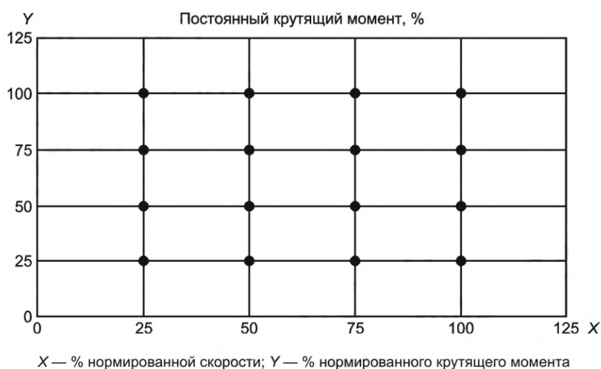
Рисунок 2 — Точки измерения, основанные на нормированном крутящем моменте
