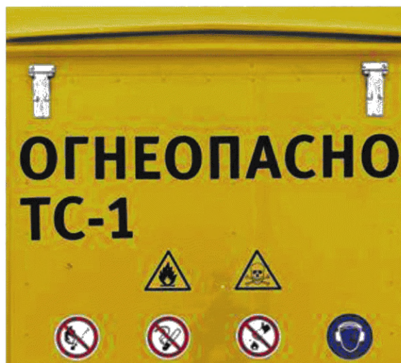
Рисунок 2 — Пример нанесения знаков безопасности на топливозаправщике
