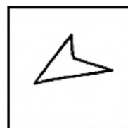
б) Угловатая форма ( l_{\max}/l_{\min} св. 2,0 до 5,0 включ.) с наличием острых углов и плоских граней
