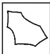
а) Угловатая форма ( l_{\max}/l_{\min} св. 2,0 до 5,0 включ.) с наличием криволинейных поверхностей
