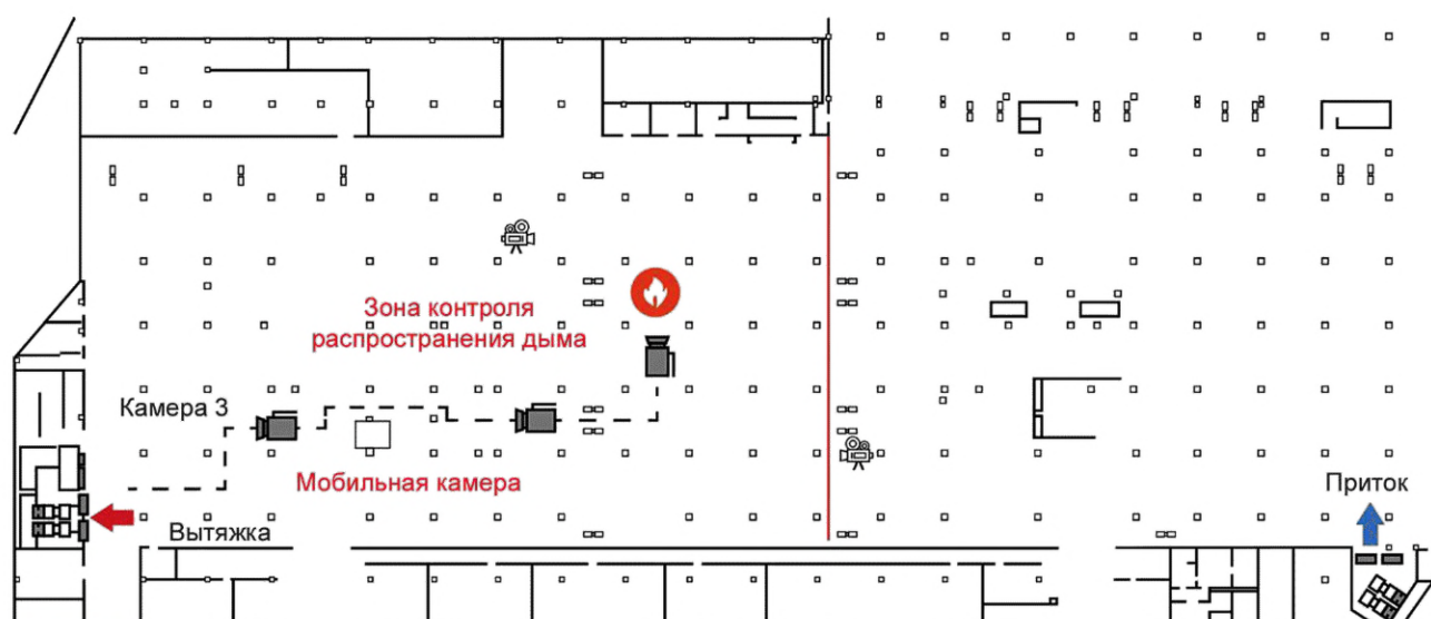
Рисунок Е.2 — Схема ИГД в дымовой зоне 5000 \text{ м}^2 , перемещение мобильной видеокамеры
