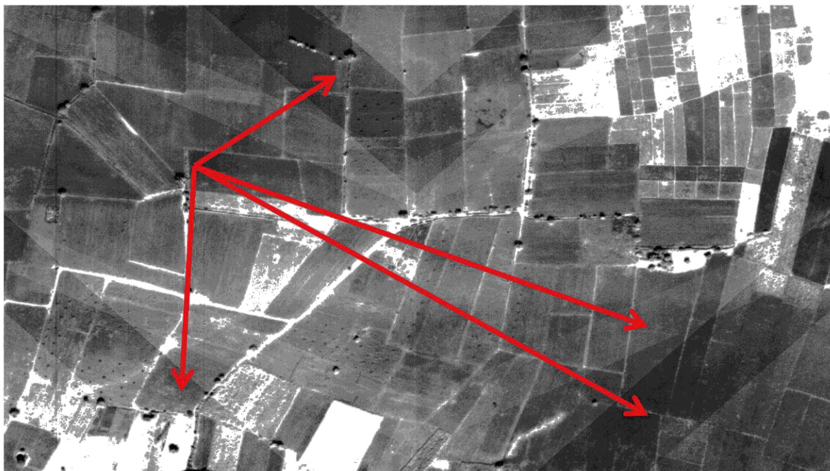
Рисунок А.9 — Неравномерная яркость (диагональные светлые и темные полосы)
