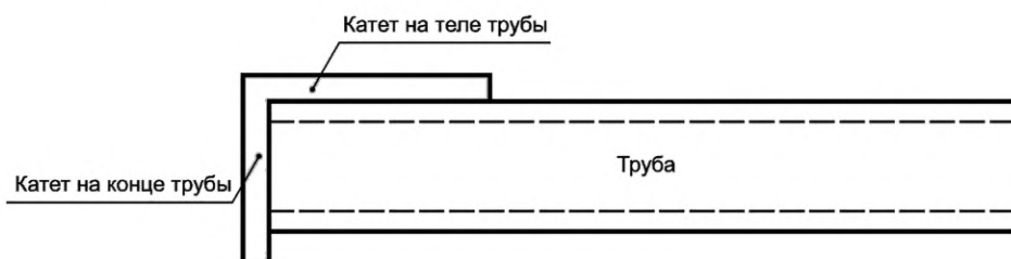
Рисунок 3 — Схема измерения прямоугольником
