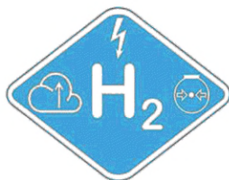
Рисунок 3 — Пример маркировки ТС на водородных топливных элементах по ГОСТ ISO 17840-4.
