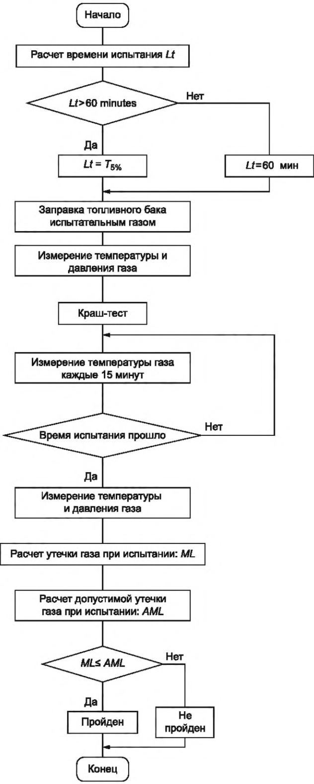
Рисунок А.4 — Алгоритм проведения испытания допустимой утечки
