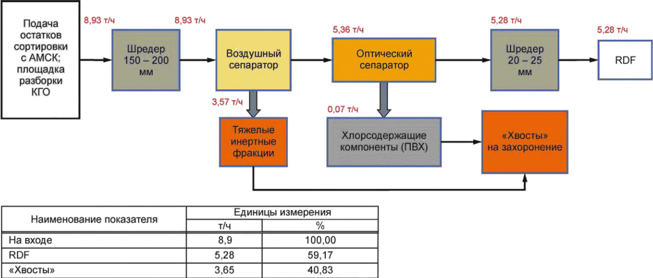
Рисунок А.1 — Блок-схема объекта производства RDF-топлива производительностью 50 000 тонн/год
