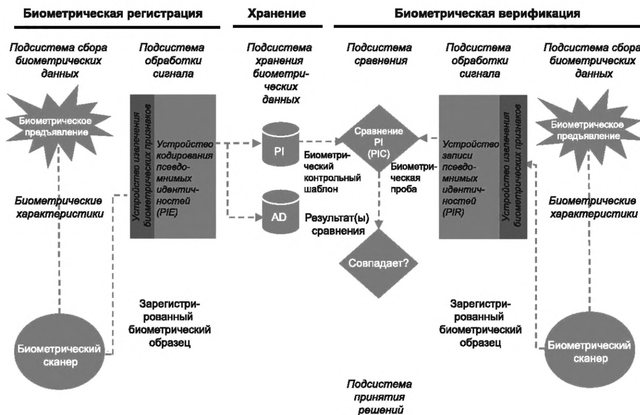
Рисунок 4 — Обобщенная модель биометрической системы, использующей возобновляемые биометрические контрольные шаблоны
