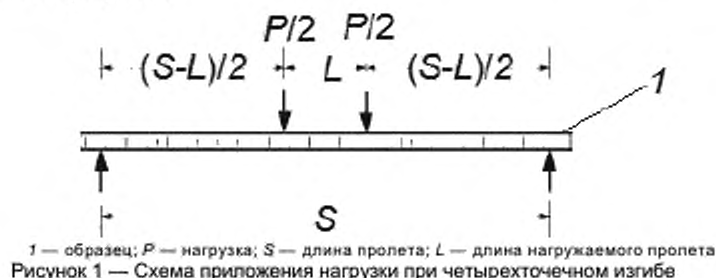
Рисунок 1 — Схема приложения нагрузки при четырехточечном изгибе
