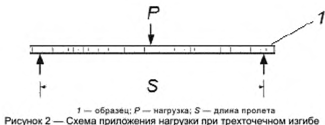
Рисунок 2 — Схема приложения нагрузки при трехточечном изгибе
