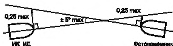
Рисунок 14а — Правильное расположение ИК ИД и фотоприемника (уточнение)
