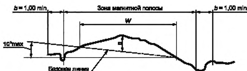
Рисунок 7 — Выпуклый профиль полосы
