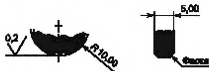
Рисунок 10 — Размеры контактной поверхности имитатора головки
