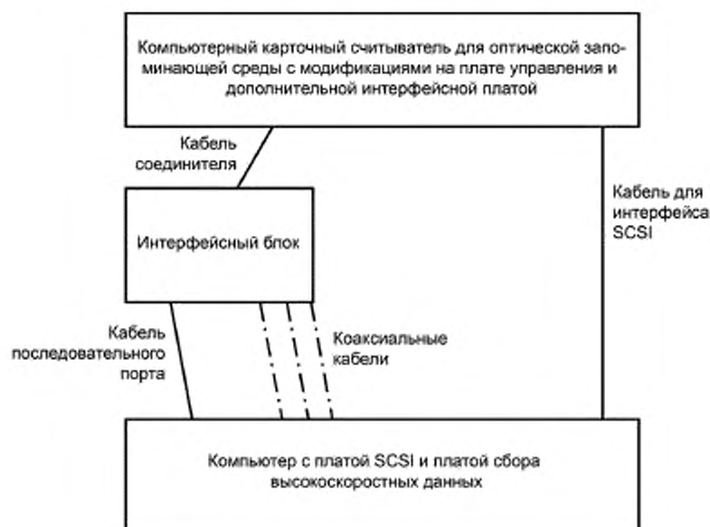
Рисунок 4 — Блок-схема устройства для испытания оптической запоминающей среды (PMT)
