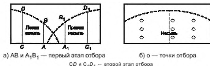
Рисунок 6 — Схема отбора проб из крытого вагона общего назначения
