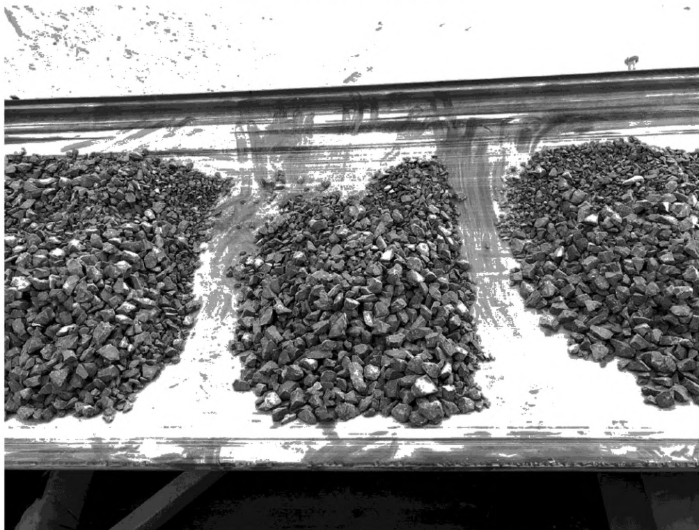
Рисунок 4 — Отбор точечной пробы без применения пробоотборной рамы
