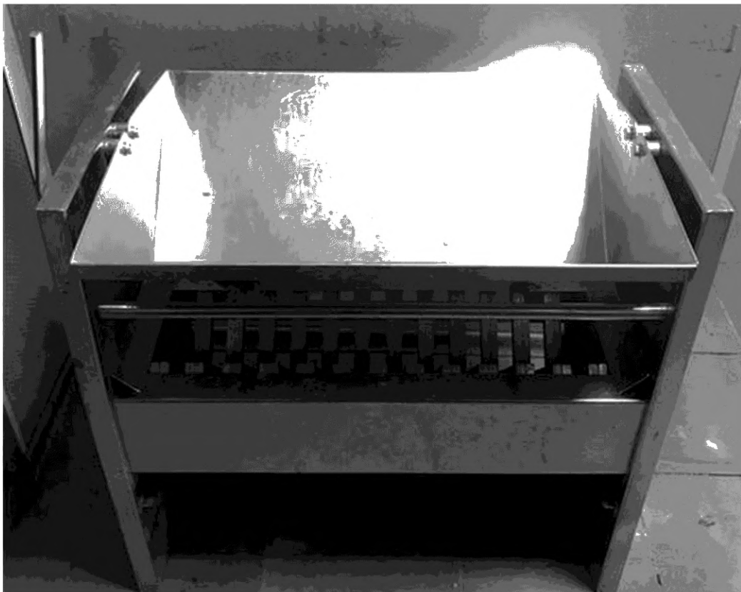
Рисунок А.3 — Пример желобчатого делителя
