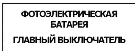
Рисунок ДА.5 — Пример знака на выключателе-разъединителе ФБ (главном выключателе ФБ) и идентичный знак МЭК
