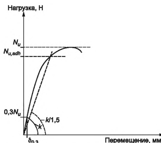
б) Оценка нагрузки при потере сцепления при плавном изменении жесткости
