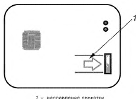
Рисунок 5 — Допустимое направление прокатки и ориентация биометрического сканера отпечатков пальцев
