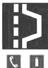
Рисунок Б.4 — Площадка для аварийной остановки
